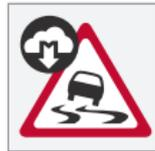
Bei Glätte-Alarm wird auf dem Fahrerdisplay dieses Symbol angezeigt, wenn sich ein Fahrzeug der von Glätte betroffenen Wegstrecke nähert. Der Alarm erfolgt sowohl im eigenen Fahrzeug
