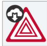
Wenn sich das eigene Fahrzeug einem Fahrzeug nähert, an dem die Warnblinkanlage eingeschaltet ist, wird auf dem Fahrerdisplay dieses Symbol angezeigt.
